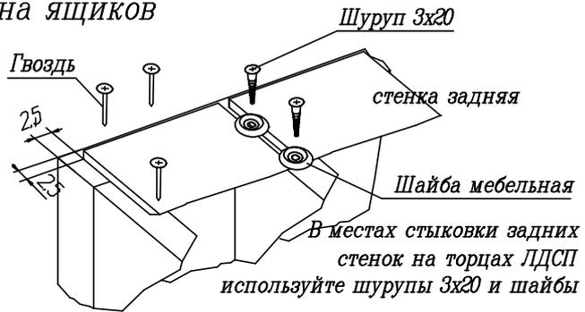
Начните сборку каркаса. Проверьте перпендикулярность и параллельность щитов и зафиксируйте с помощью задней стенки из ДВП, как указано на рисунке, не нарушая диагонали. Помните, что от этого зависит правильность работы выдвижных ящиков и створок.
