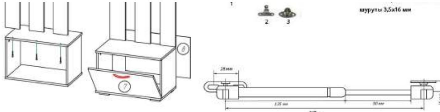
Крепление стяжки эксцентриковой
