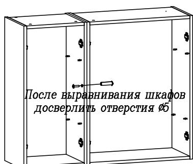
Во избежание опрокидывания шкафа, зафиксируйте его с рядом стоящими шкафами, просверлив самостоятельно отверстия φ5 мм в стенках вертикальных и скрепив их между собой стяжкой межсекционной.
