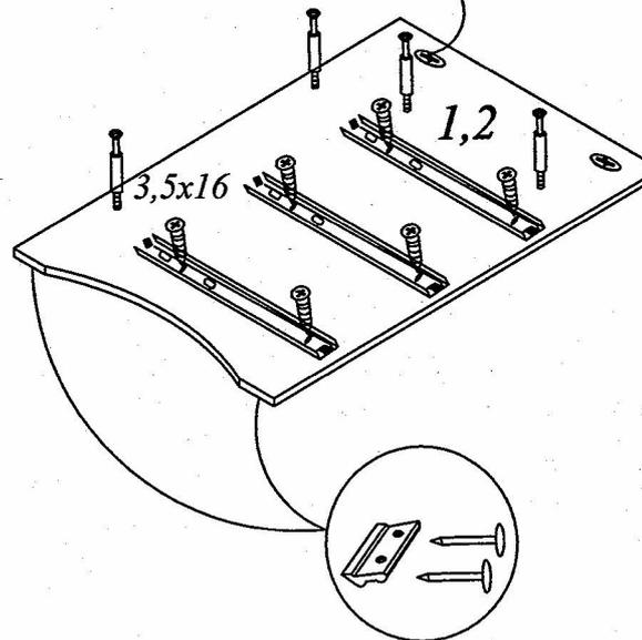
Нажать деблокировочный рычаг для снятия части 2, закрепить ее на блок ящика по наколкам для регулировочного отверстия, затем зафиксировать направляющие шурупами 3,5x16 в круглые отверстия
