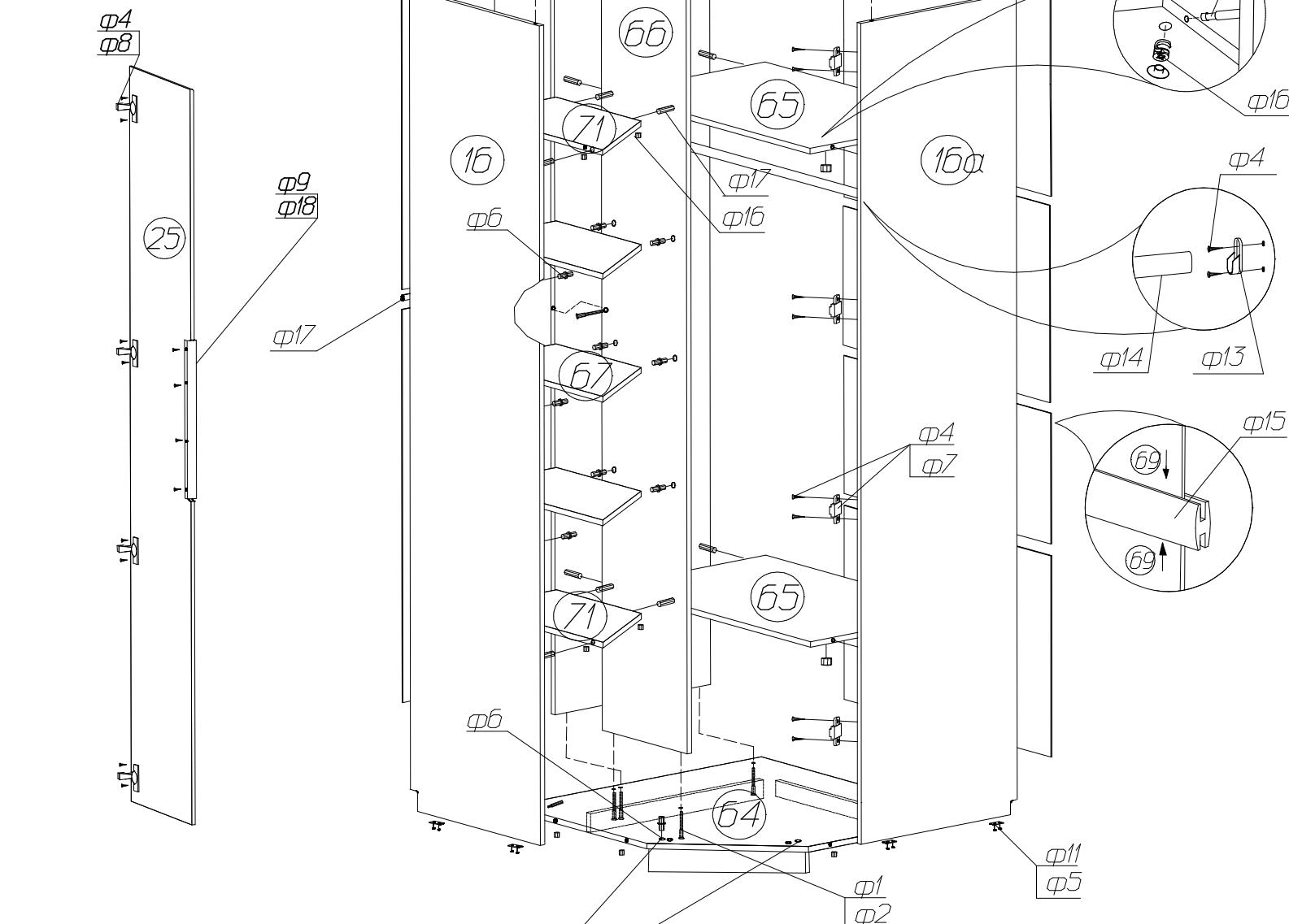
Установите полко-держатель φ6 в одно из отверстий деталей 63 и 64 в зависимости от направления открывания двери.
