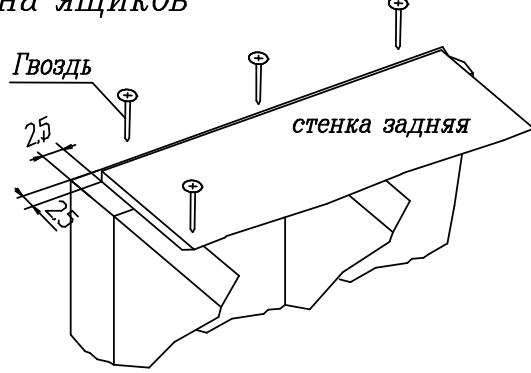
Начните сборку каркаса. Проверьте перпендикулярность и параллельность щитов и зафиксируйте с помощью задней стенки из ДВП, как указано на рисунке, не нарушая диагонали. Помните, что от этого зависит правильность работы выдвижных ящиков и створок.
