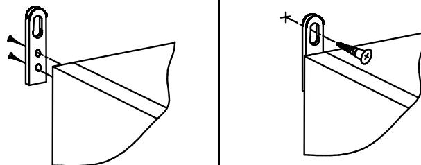
Во избежание опрокидывания шкафа, установите на задних торцевых поверхностях боковин прямой навес (см. фурнитуру) и через него притяните изделие к стене (дюбель-гвоздь в комплект не входит).
