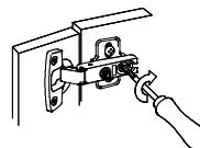
2) Затяните винт (неплотно)
