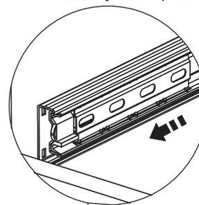
Для улучшения работы направляющей при установке системы выталкивания извлечь резиновый ограничитель хода с направляющей.
