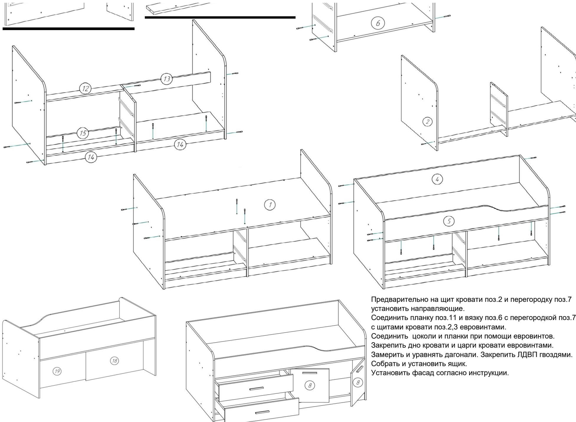
Предварительно на щит кровати поз.2 и перегородку поз.7 установить направляющие.
