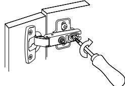
2) Затяните винт (неплотно)
