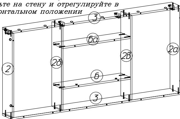
*Разложите детали фасада на ровной поверхности, установите штоки эксцентриков*
