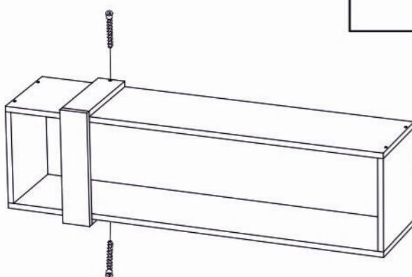
Планки (дет. 5, дет. 6) собираются отдельно от полки, затем собранная конструкция соединяется с полкой.
