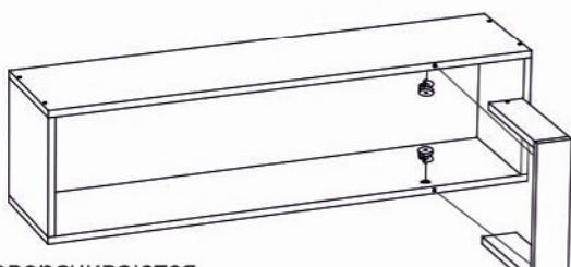
! При зеркальной сборке детали 2 и 3 меняются местами и переворачиваются.
