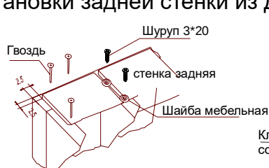
Схема установки задней стенки из ДВП
