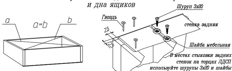
Начните сборку каркаса. Проверьте перпендикулярность и параллельность щитов и зафиксируйте с помощью задней стенки из ДВП, как указано на рисунке, не нарушая диагонали. Помните, что от этого зависит правильность работы выдвижных ящиков и створок.
