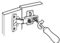
2) Затяните винт (неплотно)
