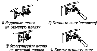
Схема установки петли
