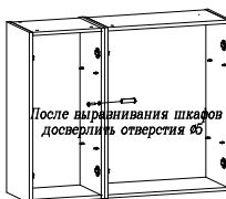
Установка и стяжка корпусов шкафов
