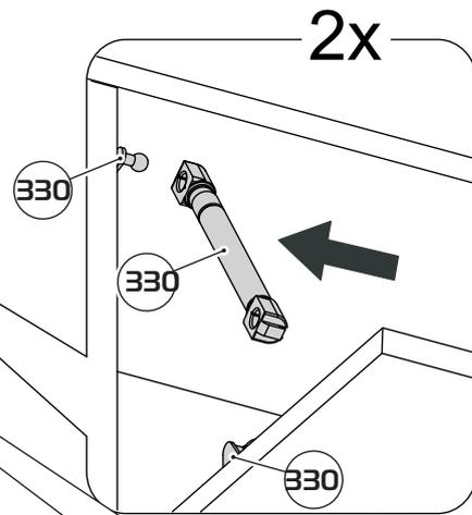
Регулировка выталкивателя по глубине.
