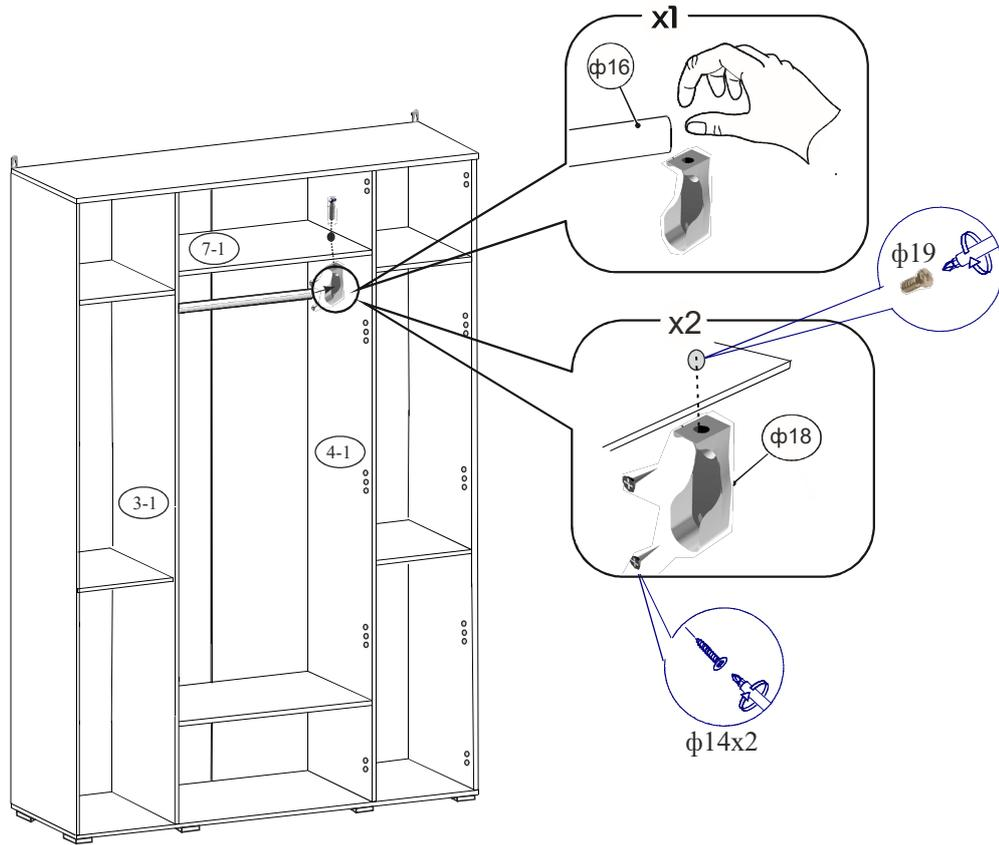
\*Перед закручиванием шурупов (φ14) необходимо наколоть дополнительные отверстия шилом.
