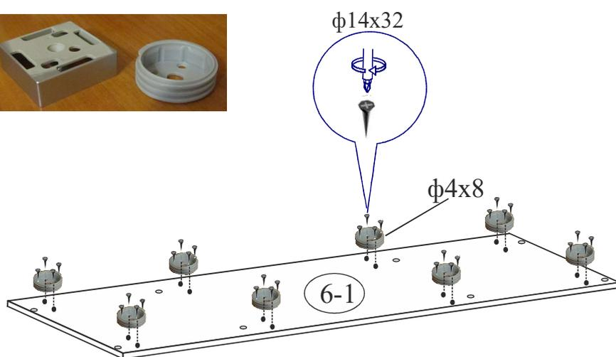
\*Перед закручиванием шурупов необходимо наколоть дополнительные отверстия шилом, через отверстия в круглой части ножки.
