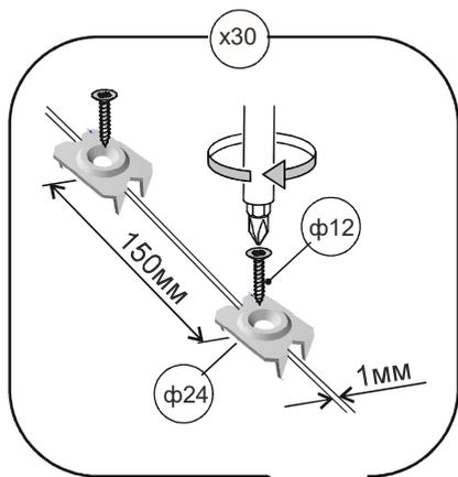
\*Дополнительно закрепите стенки задние шурупами (φ12x24) и шайбами (φ13x24) в кромку деталей (7-1, 8-1, 9-1).
