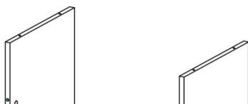
Фасадные планки поз.5,6 соединяются с боковинами шкафа
