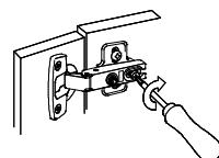
2) Затяните винт (неплотно)
