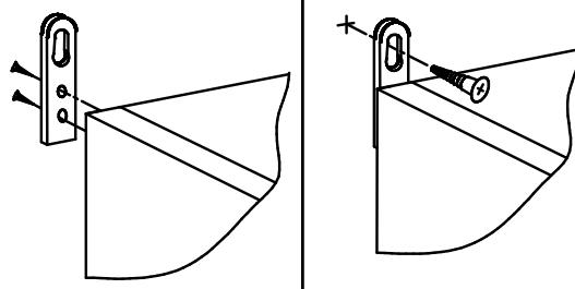
Во избежание опрокидывания шкафа, установите на задних торцевых поверхностях боковин прямой навес (см. фурнитуру) и через него притяните изделие к стене (дюбель-гвоздь в комплект не входит).
