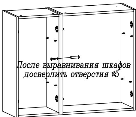
Во избежание опрокидывания шкафа, зафиксируйте его с рядом стоящими шкафами, просверлив самостоятельно отверстия Ø5 мм в стенах вертикальных и скрепив их между собой стяжкой межсекционной.
