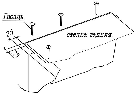
Проверьте перпендикулярность и параллельность щитов и зафиксируйте с помощью задней стенки из ДВП, как указано на рисунке, не нарушая диагонали. Помните, что от этого зависит правильность работы выдвижных ящиков и створок.
