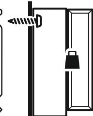
Крепежные средства идущие в комплекте, предназначены только для стен из бетона и полнотелого кирпича!
