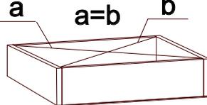
Начните сборку каркаса. Проверьте перпендикулярность и параллельность щитов и зафиксируйте с помощью задней стенки из как указано на рисунке, не нарушая диагонали. Помните, что от этого зависит правильность работы выдвижных ящиков и створок.
