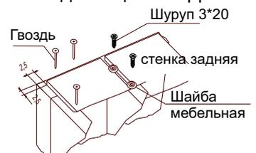
В местах стыковки задних стенок на торцах ЛДСП используйте шурупы 3\*20 и шайбы.
