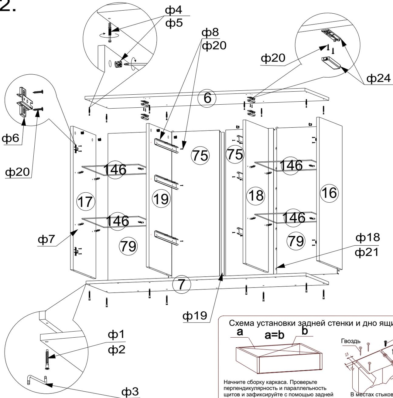
Схема установки задней стенки и дно ящика из ДВП
