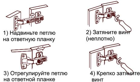
Схема регулировки петли
