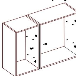
Во избежании опрокидывания шкафа, зафиксируйте его с рядом стоящими шкафами, просверлив самостоятельно отверстия ф5мм в стенках вертикальных и скрепив их между собой стяжкой межсекционной.
