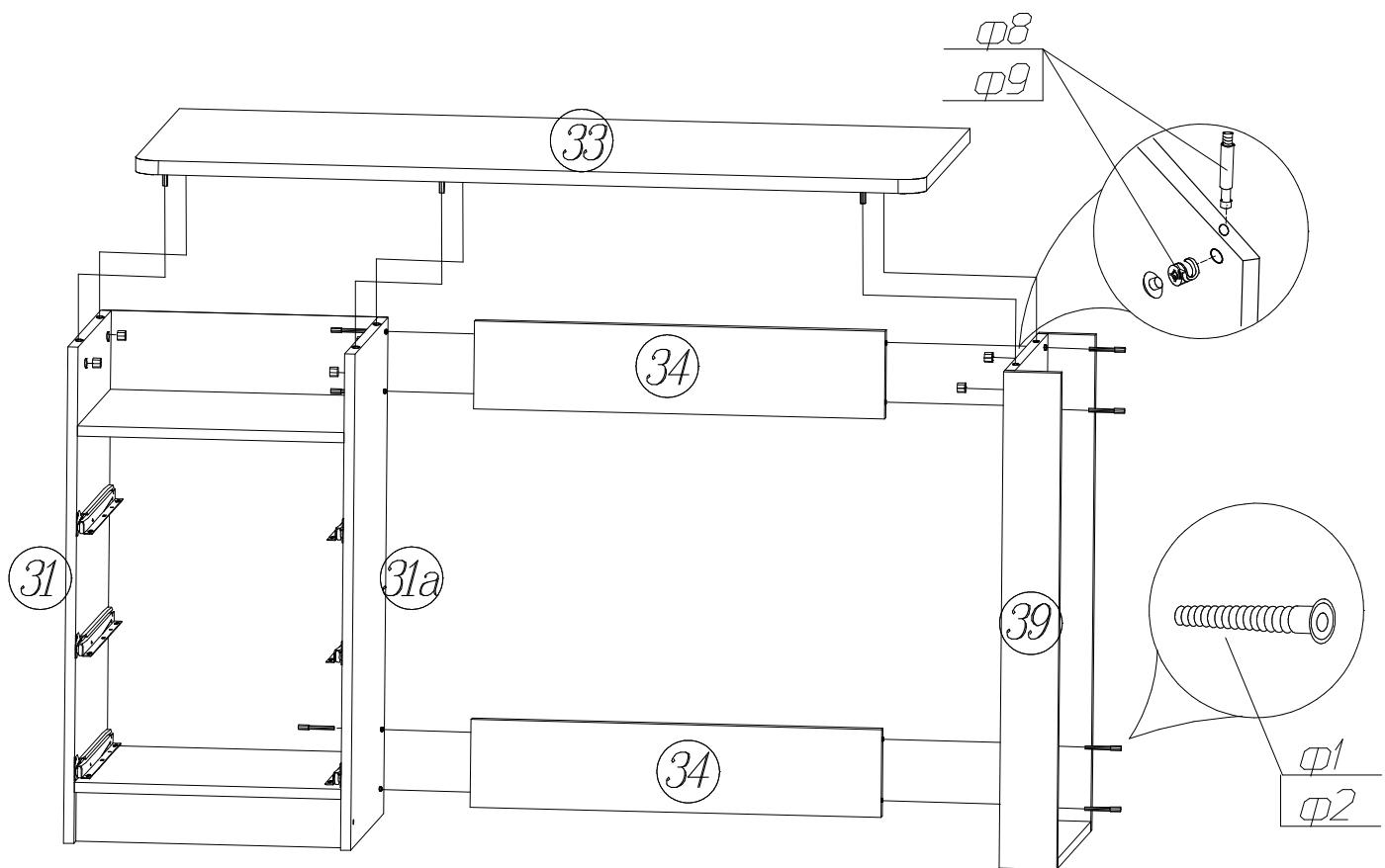
*Схема установки задней стенки тумбочки и ящиков.*
