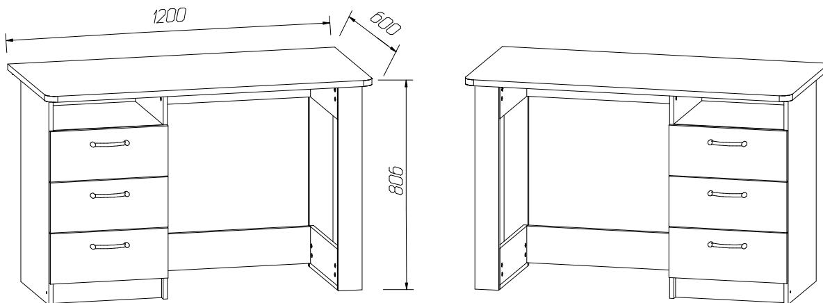
Допускается вариант зеркальной сборки
