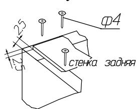
Начните сборку каркаса. Проверьте перпендикулярность и параллельность щитов и зафиксируйте с помощью задней стенки из ДВП как указано на рисунке не нарушая диагонали. Помните, что от этого зависит правильность работы выдвижных ящиков и створок.
