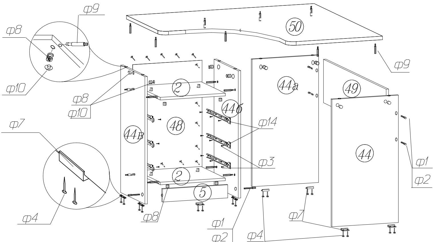
*Схема установки задней стенки тумбочки и яна ящиков.*
