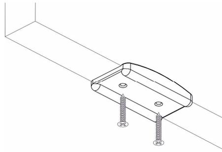
Для большей прочности фасад ящика желательно закрепить с вязкой ящика саморезами 4x25мм.
