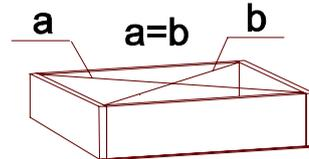
Начните сборку каркаса. Проверьте перпендикулярность и параллельность щитов и зафиксируйте с помощью задней стенки из как указано на рисунке, не нарушая диагонали. Помните, что от этого зависит правильность работы выдвижных ящиков и створок.
