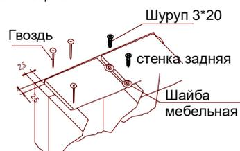
В местах стыковки задних стенок на торцах ЛДСП используйте шурупы 3\*20 и шайбы.
