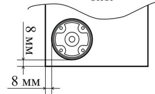
В накладку ящика вворачивается дюбель эксцентриковой стяжки. Ящик складывается согласно схеме, в паз вставляется дно, накладка стягивается с корпусом ящика. **Предварительно просверлив отверстия Ø 2,5 мм**, крепятся направляющие шурупами 4х13. Шурупом 4х16 через фиксатор приворачиваем дно ящика (рис. №6)
